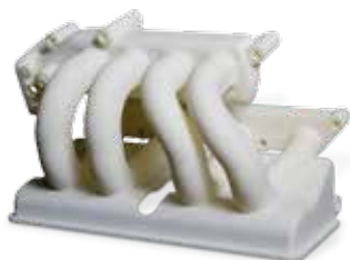
Collecteur imprimé en DuraForm ProX PA
